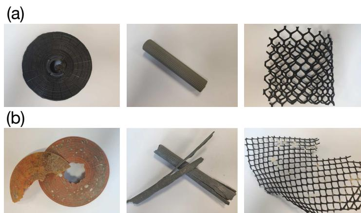
**Figure 24.** Photographies des trois principaux plastiques ostréicoles utilisés par les professionnels et potentiellement retrouvés sur les littoraux (la coupelle, le tube de captage et la poche ostréicole). **(a)** Plastiques ostréicoles neufs et **(b)** vieillis dans l'environnement des Pertuis Charentais. Photographies réalisées lors des prélèvements sur le littoral charentais (© Arno Bringer).
