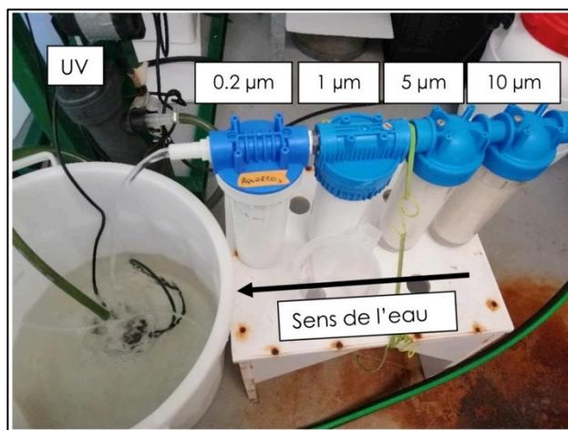
**Figure 30.** Système de filtration pour l'eau de mer. Photographie réalisée au cours des expérimentations (© Arno Bringer).
