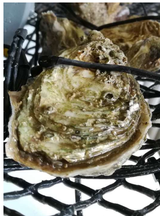
Figure 32. Huître équipée d'électrodes reliées au valvomètre pour l'acquisition des données de comportement valvaire. D'après les travaux de Tran et al. (2003).
