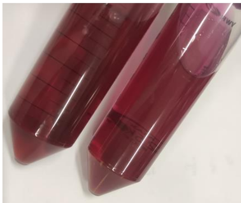
Figure III. 5. Solution colloïdale à 1 mg/mL de nanoparticules d'or de 4,8 nm.
