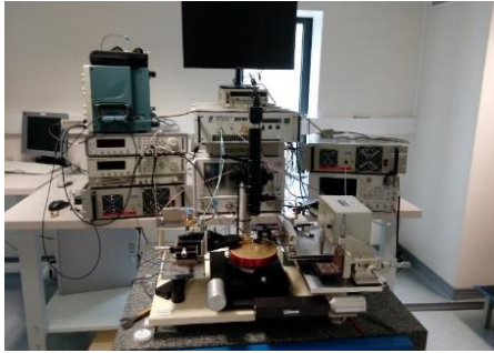
Figure 25 Photo du banc load pull actif et son synoptique optimisé par notre groupe [30]
