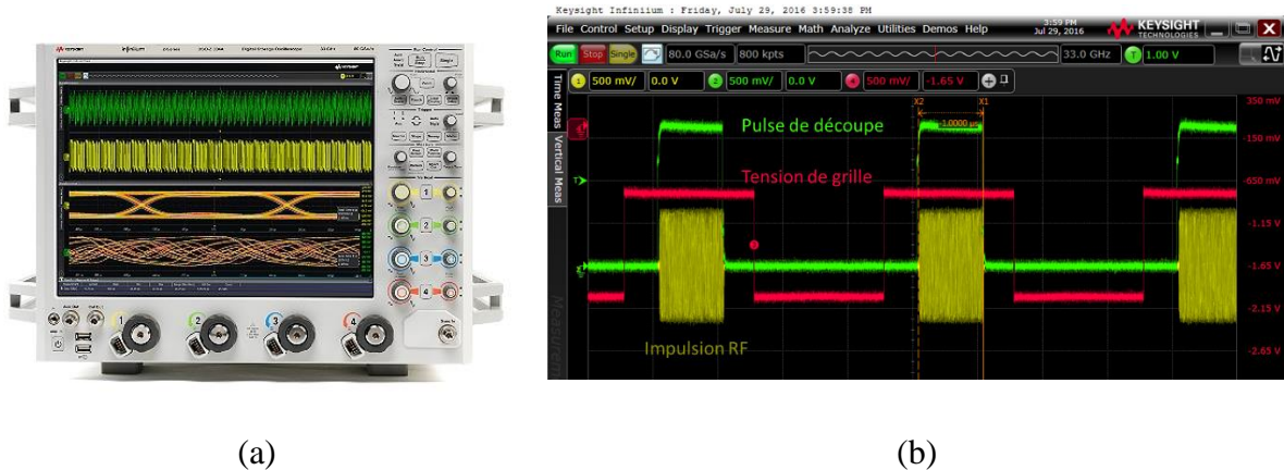
Figure 33 Oscilloscope Keysight Infiniium 33GHz (a). Observation d'un signal RF 18GHz impulsionnel à l'oscilloscope Infiniium (b)
