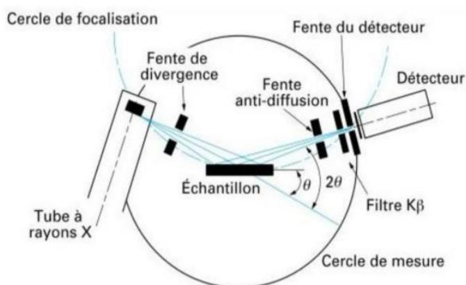
Figure 99 : Schéma d'un diffractomètre à rayons X
