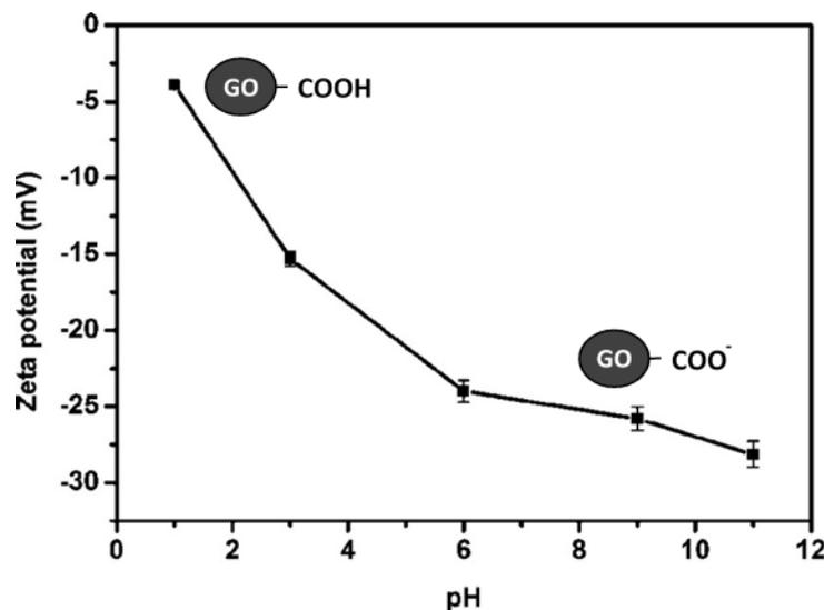
Figure 21 : Potentiel Zêta de  $1 \text{ mg.mL}^{-1}$  de GO dispersé dans l'eau à différents pH [145].
