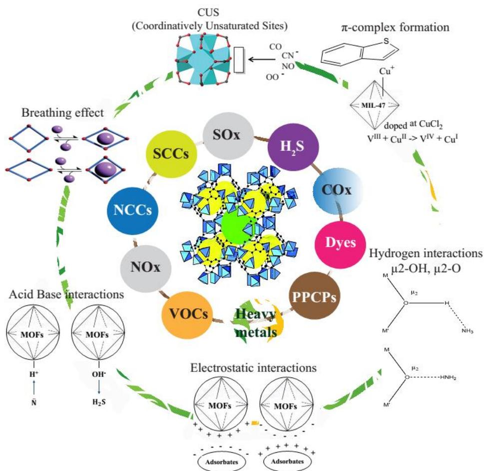
Figure 8 : Mécanismes d'adsorption des principaux polluants sur les MOFs.
