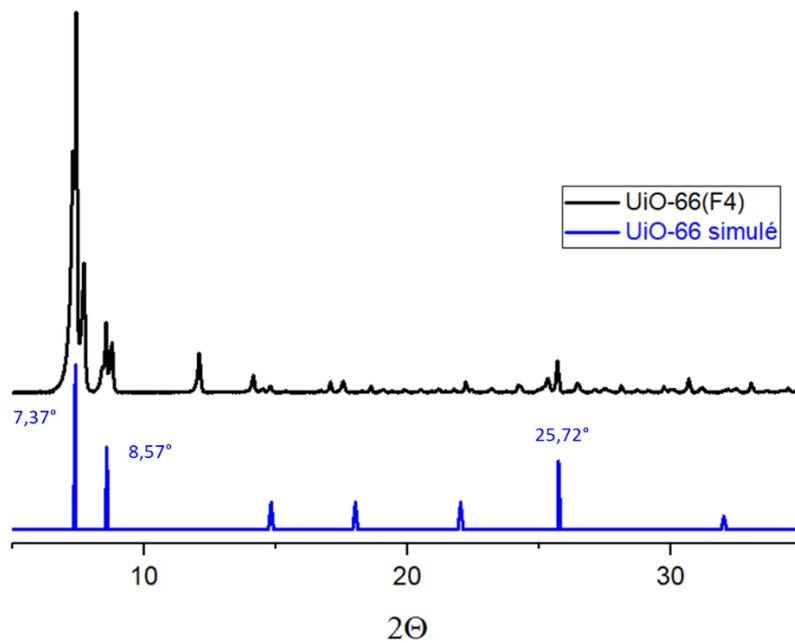
Figure 73 : Diffractogramme de la poudre d'UiO-66(F4) après synthèse.
