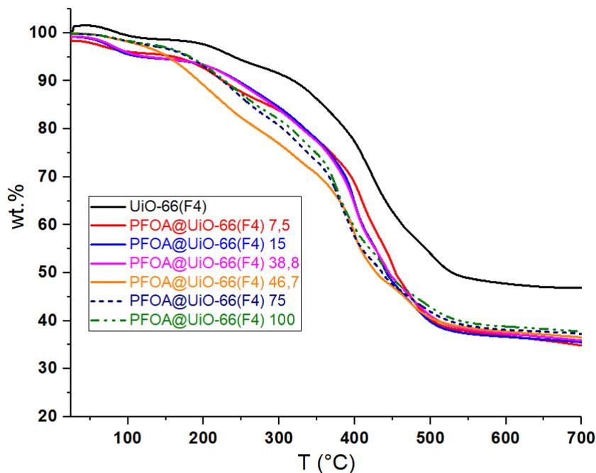
Figure 85 : Courbes ATG des matériaux PFOA@UiO-66(F4).
