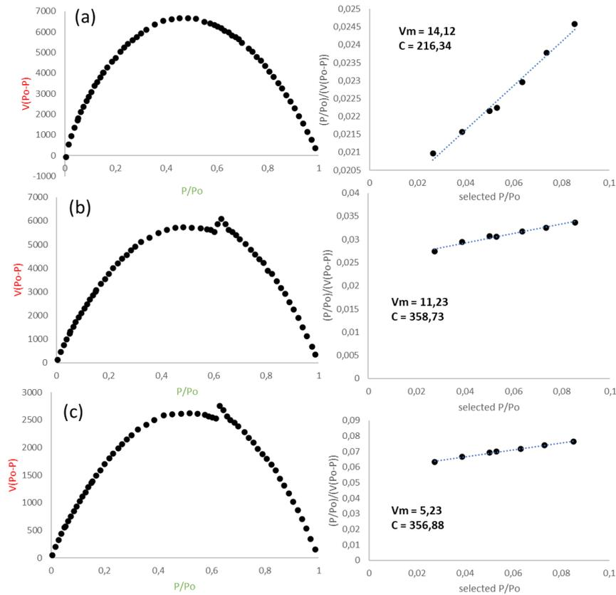
Figure 110 : Domaines de calcul BET sur les polyHIPEs à différentes concentrations en PVA a) M100/10/0,25, b) M100/10/0,1 et c) M100/10/0
