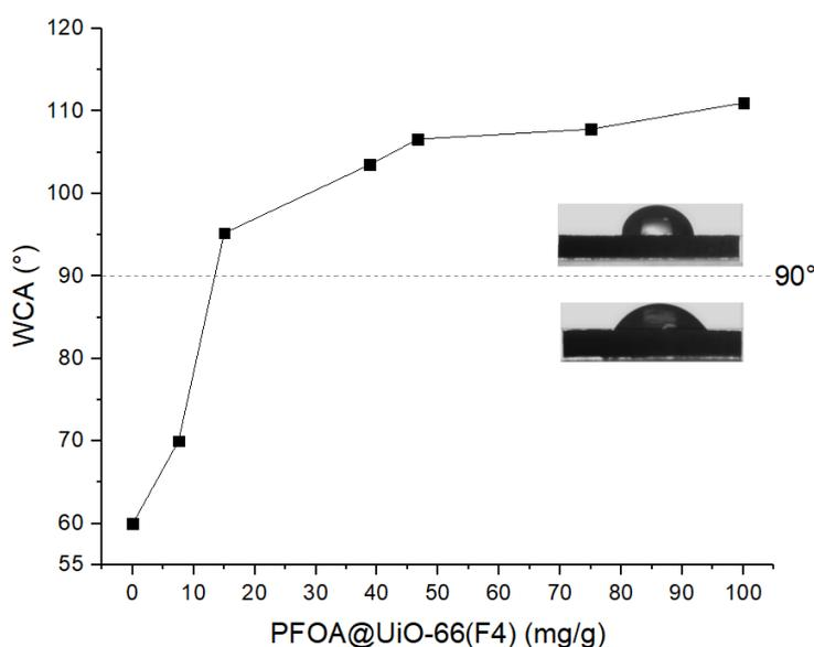
Figure 86 : Evolution de l'angle de contact à l'eau (WCA) des particules PFOA@UiO-66(F4), qui caractérise l'hydrophobicité des particules.
