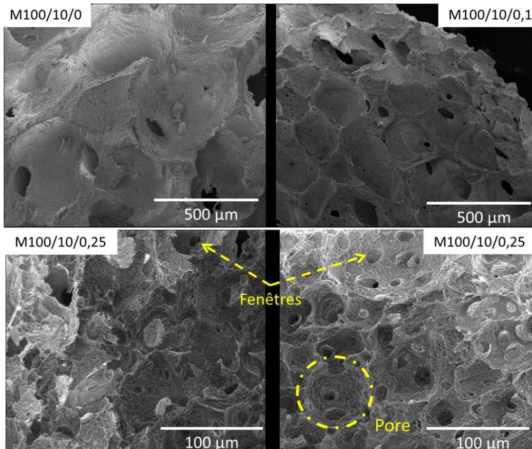
Figure 60 : Evolution des pores et fenêtres des MIL-96(Al)@polyHIPEs.
