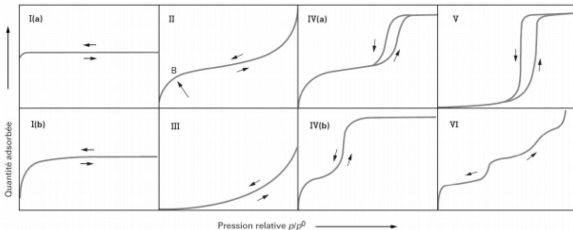
Figure 102 : Types d'isothermes d'adsorption et désorption
