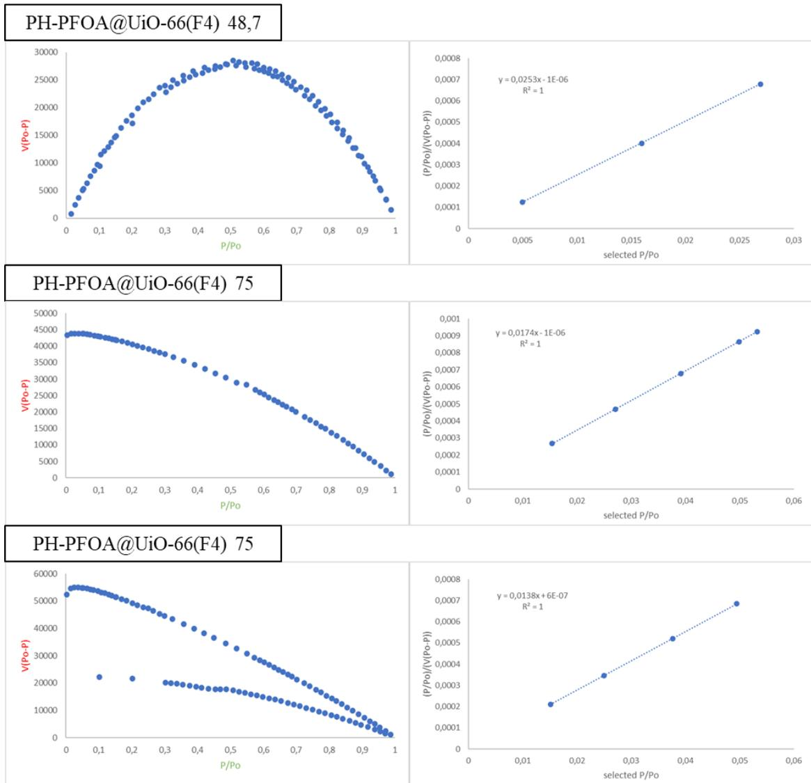
Figure 113 : Domaine du calcul de la surface BET des matériaux polyHIPEs à base d'UiO-66(F4)
