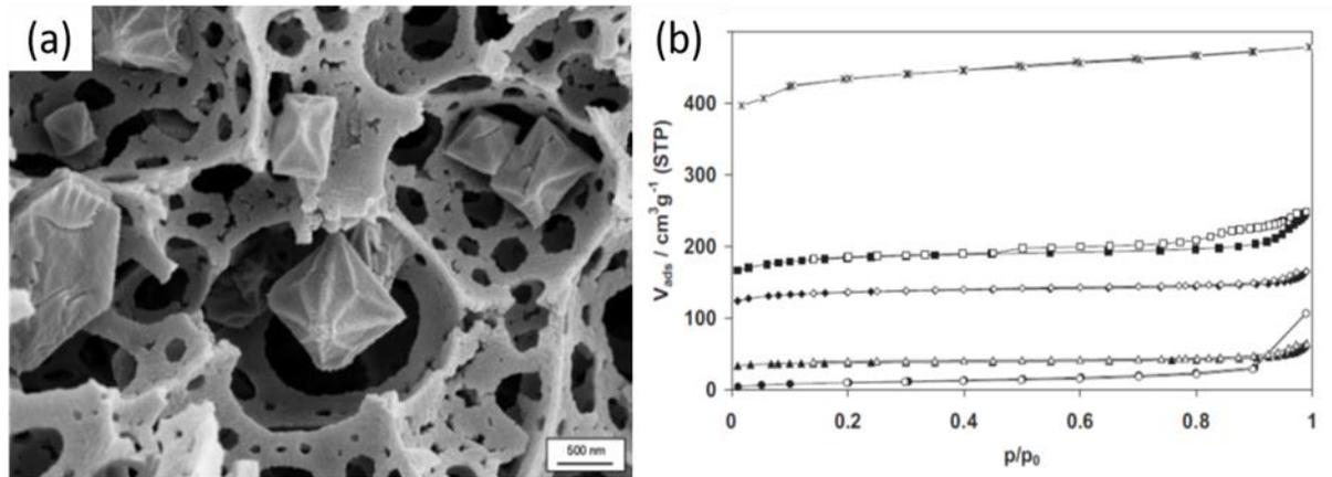
Figure 14 : (a) Image MEB de MOFs HKUST-1 intégrées dans un polyHIPE ; (b) Isothermes d'adsorption et de désorption de  $\text{N}_2$  (respectivement symboles solides et vides) d'un HKUST-1@polyHIPE après des étapes d'imprégnation successives : pas d'imprégnation (cercles), une imprégnation (triangles), deux imprégnations (losanges) et trois imprégnations (carrés). Les étoiles représentent l'isotherme de la HKUST-1 pure [98].
