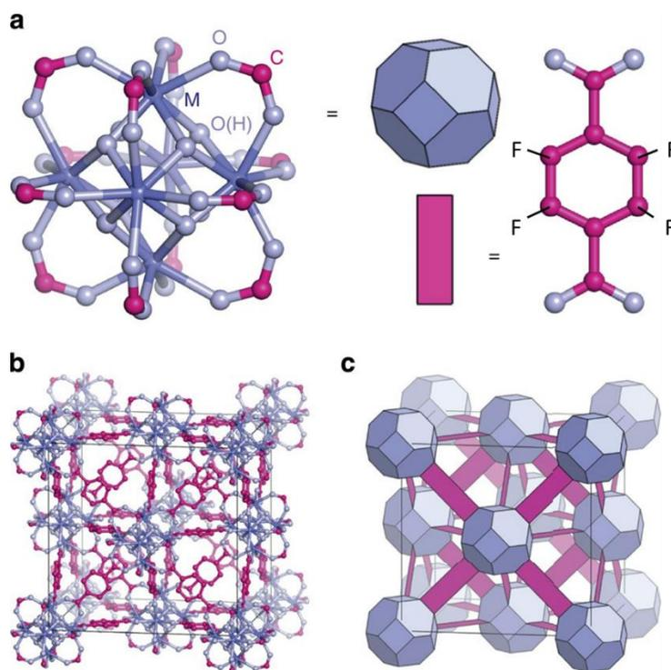
Figure 71 : (a) Cluster métallique UiO-66(F4), (b) Topologie cfc dans laquelle chaque cluster est relié à 12 clusters voisins, (c) Représentation polyédrique simplifiée de la même structure de réseau [241].
