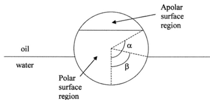
Figure 19 : Géométrie d'une particule de Janus adsorbée à une interface huile-eau. Les surfaces relatives des régions polaires et apolaires de la particule sont paramétrées par l'angle  $\alpha$ . La profondeur d'immersion de la particule dans l'interface huile-eau est paramétrée par l'angle  $\beta$  [127].
