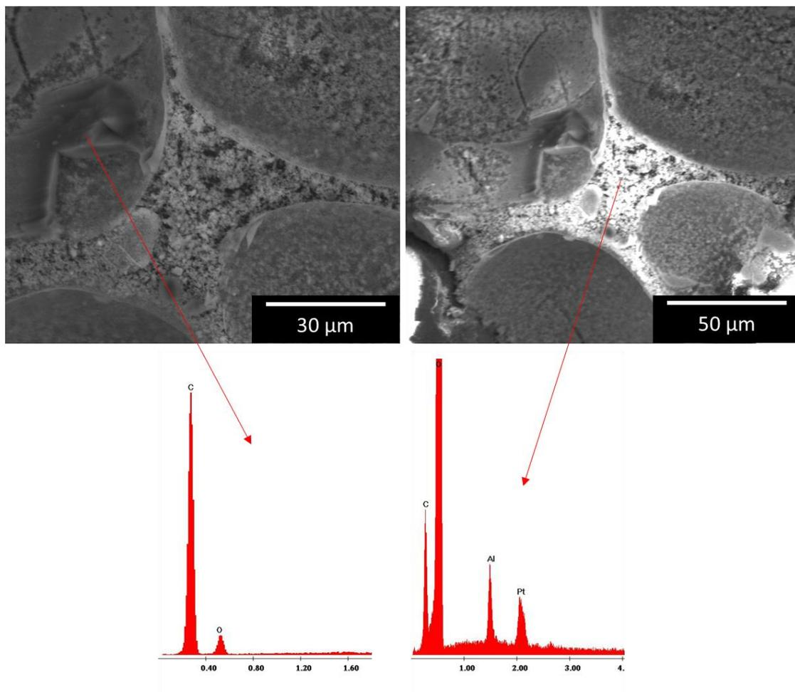
Figure 107 : Images CryoMEB à congélation à haute pression (HPF) d'une émulsion de Pickering à  $\phi=0,8$  stabilisé par 1wt% de MIL-96(Al), avec en surbrillance les particules de MOFs, la position du MIL-96(Al) a été révélée par l'analyse EDX (en rouge).
