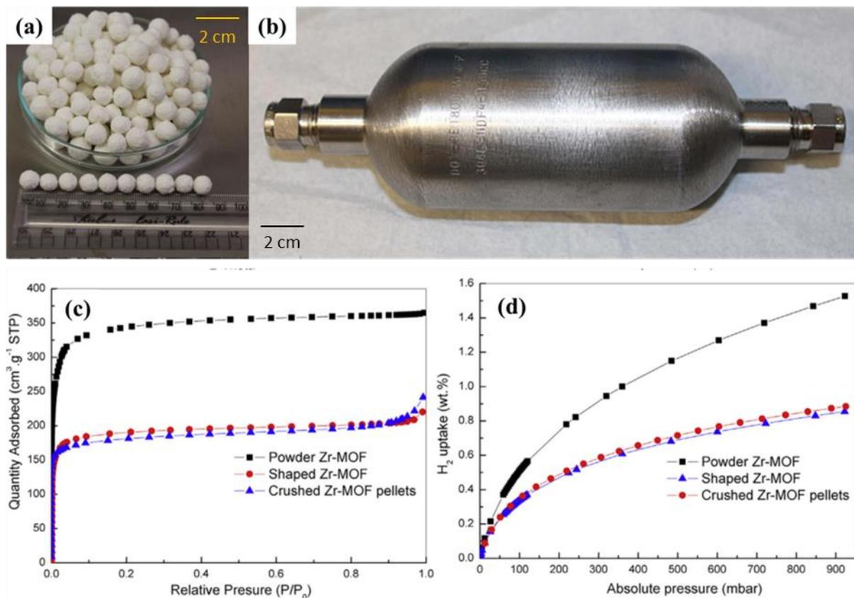
Figure 9 : (a) UiO-66 en forme de granulés sphériques d'un diamètre d'environ 8 mm ; (b) Cylindre rempli de granulés d'UiO-66 ; (c) Isothermes de sorption N<sub>2</sub>, et (d) Isothermes de sorption H<sub>2</sub> à 77 K et 1 Bar sur de la poudre, des sphères et sphères écrasées d'UiO-66 [76].
