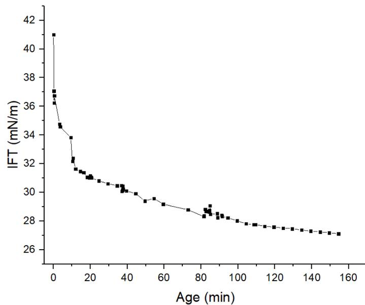
Figure 77 : Mesure de la tension interfaciale entre la paraffine et l'eau en présence de UiO-66(F4).
