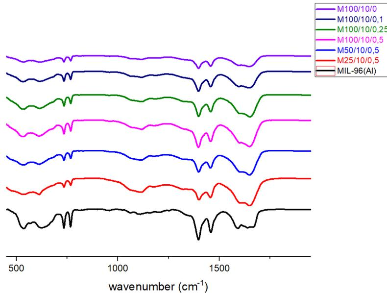
Figure 65 : Spectre IR de la poudre de MIL-96(Al) et des polyHIPEs.
