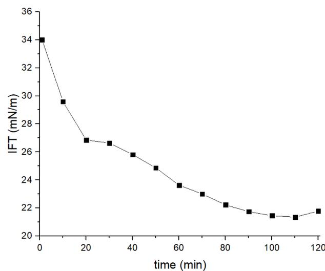
Figure 39 : Evolution de la tension interfaciale (IFT) au cours du temps sur une goutte de paraffine générée dans une suspension de MIL-96(Al) à  $0,125 \text{ mg.mL}^{-1}$ .
