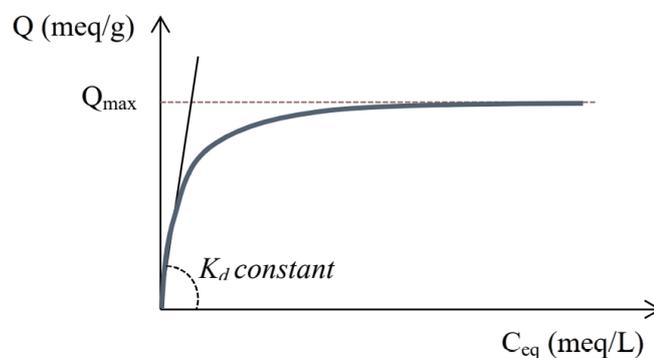
Figure 33 : Exemple d'une isotherme de sorption modèle.
