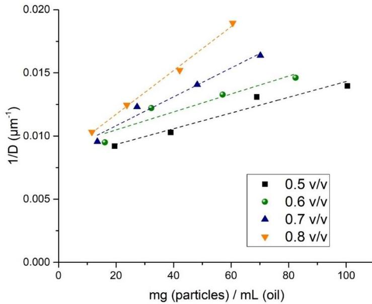
Figure 45 : Inverse du diamètre moyen des gouttelettes ( $1/D$ ) en fonction du rapport masse des particules MIL-96(Al) sur le volume de paraffine dans des émulsions avec des ratios volumiques de 0,5 à 0,8. La régression linéaire est représentée par les lignes en pointillés.
