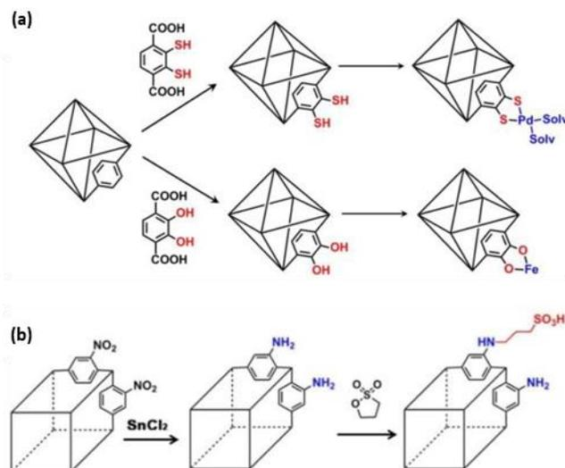
Figure 6 : Introduction de site catalytique dans le MOF (a) UiO-66 [31,32] et (b) MIL-101 par PSM [33].
