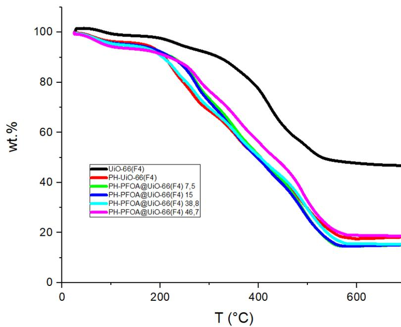
Figure 117 : Courbes ATG des monolithes polyHIPEs
