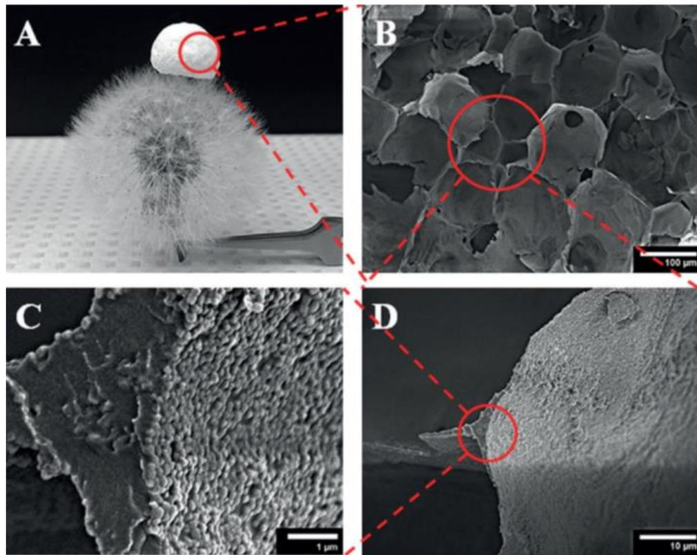
Figure 28 : A) Image optique du monolithe poreux MOF/PVA sur une tête de fleur de pissenlit ; B) -D) Images MEB du monolithe poreux MOF/PVA [167].
