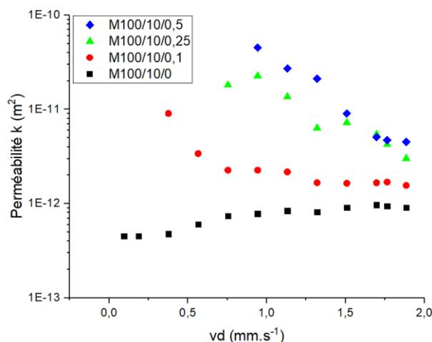
Figure 70 : Evolution de la perméabilité à l'éthanol mesurée sur des polyHIPEs.
