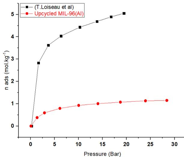
Figure 111 : Comparaison des isothermes d'adsorption de CO<sub>2</sub>, du MIL-96(Al) présents dans nos travaux ( $Q_{\max}=1,15 \text{ mol.kg}^{-1}$ ) et du MIL-96(Al) synthétisé par T. Loiseau et al [174] ( $Q_{\max}=5 \text{ mol.kg}^{-1}$ ).
