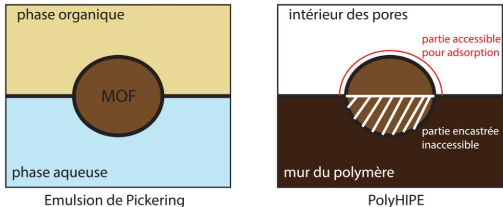
Figure 63 : Schéma de l'accessibilité de la particule de MOF après polymérisation de la phase aqueuse.
