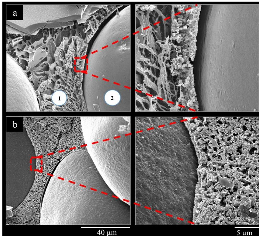
Figure 50 : Images Cryo-MEB d'émulsions avec un ratio volumique de paraffine de 0,8 et des concentrations de MIL-96(Al) de (a) 1 wt. % et (b) 3,5 wt.%. (1) Phase aqueuse continue concentrée en MIL-96(Al) et (2) gouttelette d'huile.
