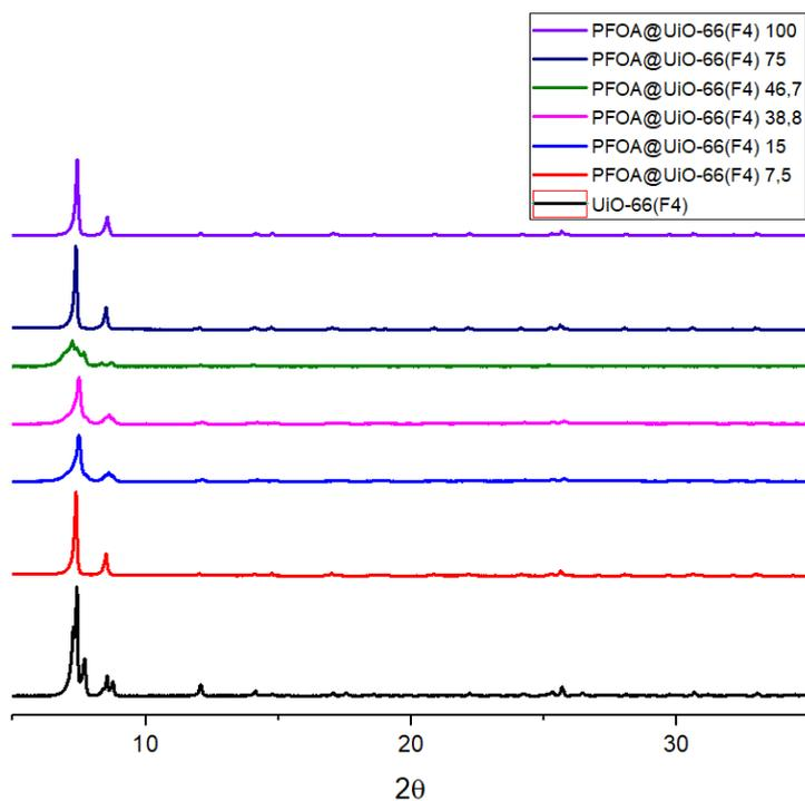
Figure 82 : Diffractogrammes des poudres de PFOA@UiO-66(F4).
