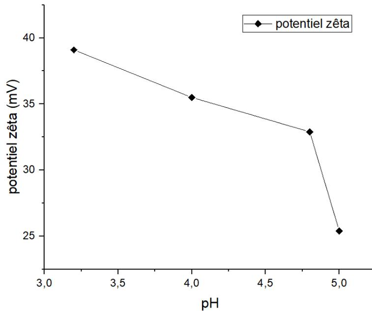
Figure 76 : Potentiel zêta des particules d'UiO-66(F4) en suspension.
