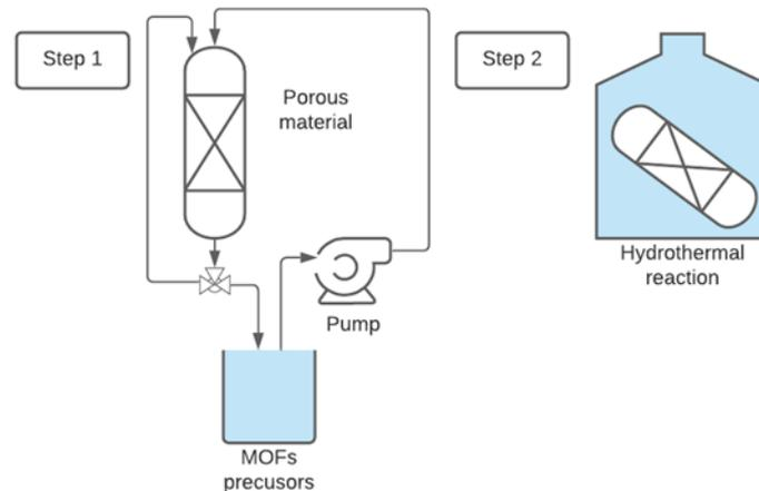
Figure 13: Schématisation des étapes d'imprégnation de supports poreux par des MOFs.
