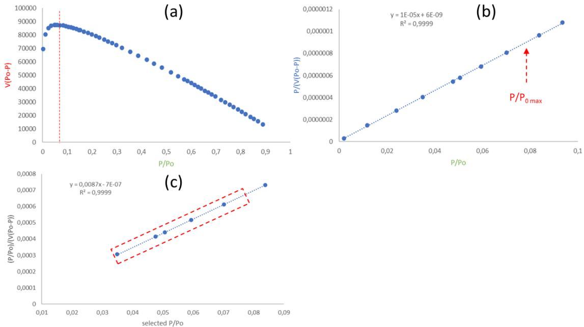
Figure 29 : Exemple de détermination du domaine sur lequel la surface BET est calculée en accord avec les critères d'applicabilité aux MOFs.
