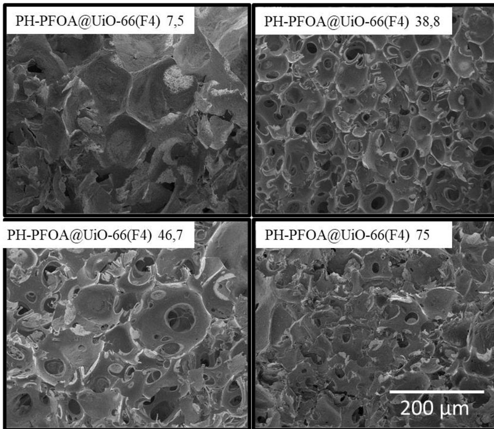
Figure 116 : Quelques images MEB de polyHIPEs
