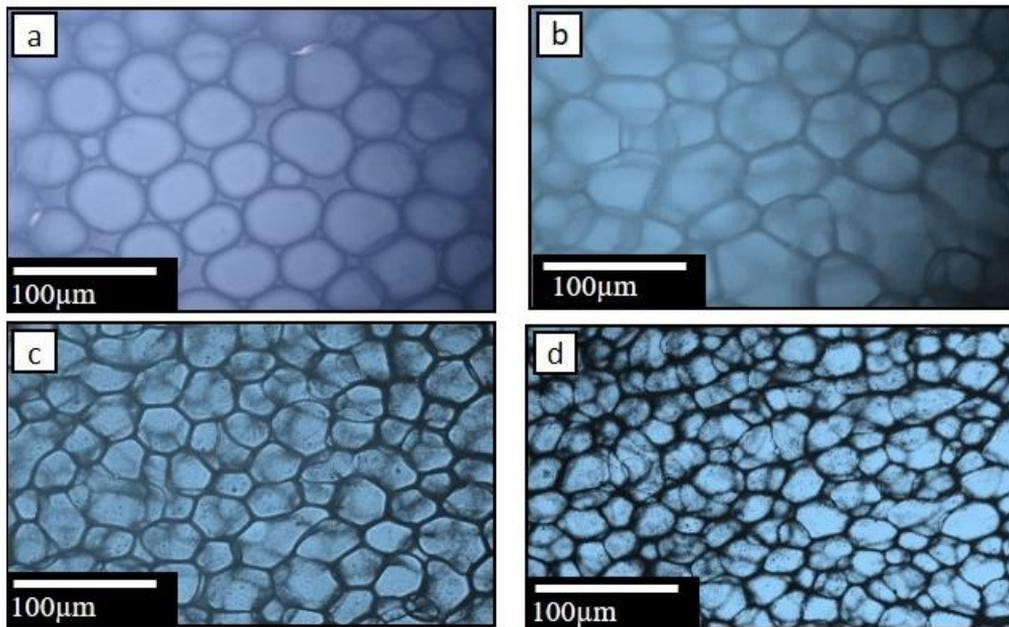
Figure 44 : Images de microscopie optique d'émulsions contenant 5 wt. % de MIL-96(Al) et des ratios volumiques de paraffine de (a) 0,5, (b) 0,6, (c) 0,7 et (d) 0,8.
