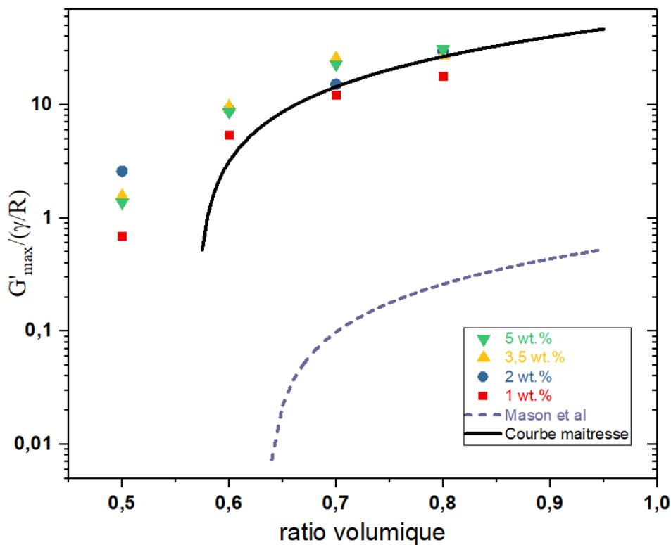
Figure 54: Evolution de  $G'_{max}$  normalisé par  $\frac{\gamma}{R}$  pour des émulsions ayant des concentrations différentes en MIL-96(Al), avec en pointillés la courbe des tensioactifs (Mason et al[219]) et en trait plein, la courbe maitresse.
