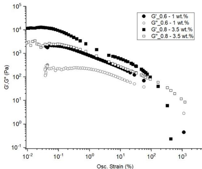
Figure 51 : Exemples de données rhéologiques oscillatoires obtenues avec des domaines viscoélastiques linéaires : modules de stockage et de perte en fonction de la contrainte d'oscillation pour deux émulsions avec des ratios volumiques de paraffine de 0,6 et 0,8 et respectivement 1 et 3,5 wt. % en particules de MIL-96(Al).
