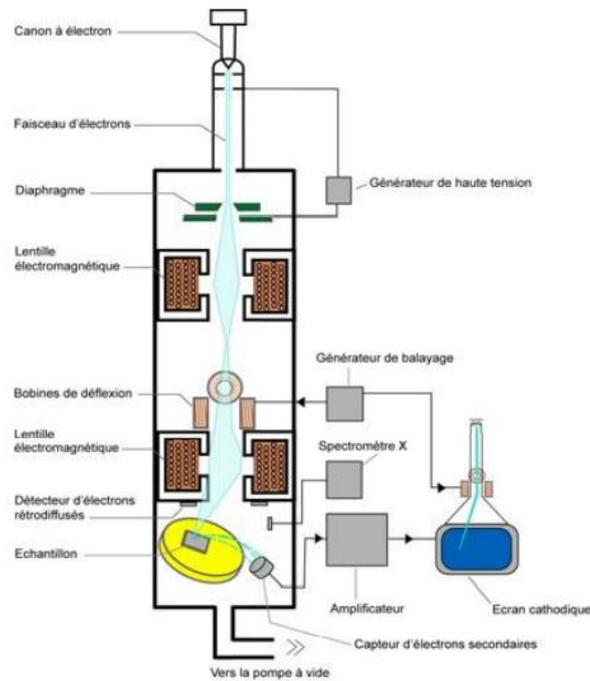
Figure 101 : Schéma représentatif du microscope électronique à balayage
