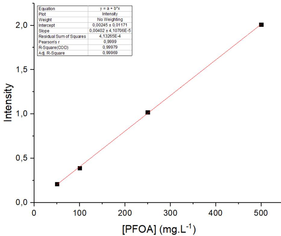
Figure 114 : Courbe de calibration pour les analyses RMN
