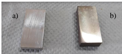
Figure 40 : Images de 2 échantillons de MgZr de 20 x 10 mm 2 , a) non poli et b) poli.
