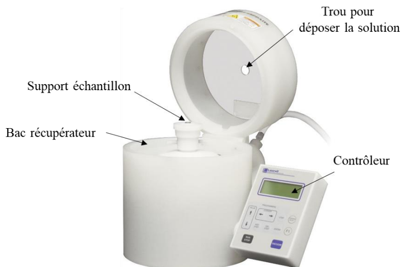
Figure 113 : Image du spin-coater utilisée lors de la préparation des couches minces.
