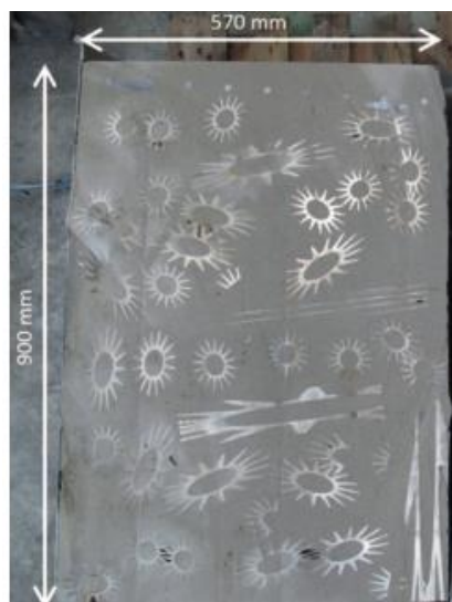
Figure 6 : Gains en alliages MgZr immobilisées dans une matrice de géopolymère [14].
