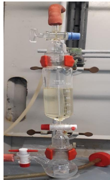
Figure 132 : Image du montage permettant la mise en résine d'un échantillon.
