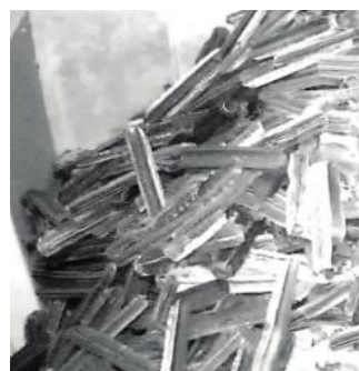
Figure 2 : Image de gaines de MgZr issues du réacteur G2-G3 stockées dans une fosse au CEA Marcoule [14].
