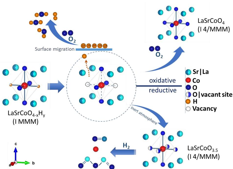
**Figure 3** - Une représentation de l'évolution des hydrures et des transformations de phases en milieux oxydants/réducteurs.
