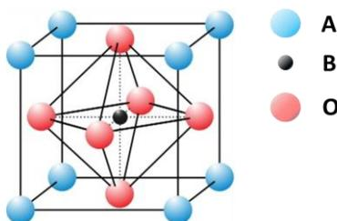
**Figure 1** – Un modello della struttura perovskite  $ABO_3$ .
