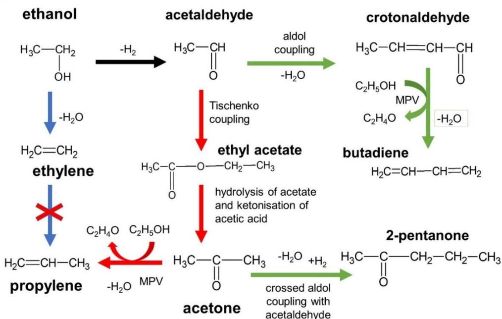
**Figure 4** - Parcours de réaction principaux dans la conversion de l'éthanol sur pérovskites LaAlO<sub>3</sub> dopées au Ga et Co.
