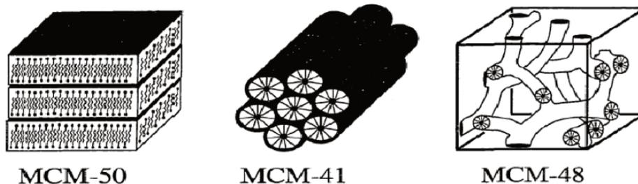
Figure 24 : Exemple de différentes silices mésoporeuses.
