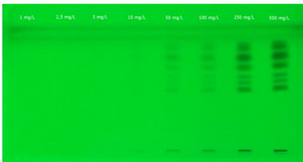
Figure 68 : Détection à 254 nm du mélange des standards 1-15 déposé à différentes concentrations et analysé avec la méthode HPTLC-1D N
