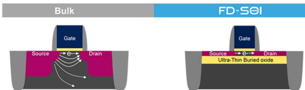
Figure 175 Comparaison entre un transistor MOS réalisé sur BULK et sur SOI
