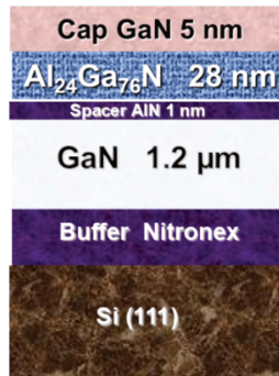
Figure 33-Hétérostructure de l'échantillon CCO016
