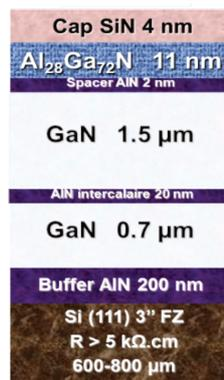
Figure 56 Structure épitaxiale de l'échantillon CC0090
