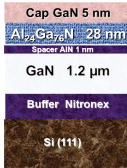
Figure 33-Hétérostructure de l'échantillon CCO016
