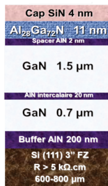
Figure 56 Structure épitaxiale de l'échantillon CC0090
