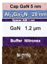
Figure 63-Hétérostructure de l'échantillon CC0016
