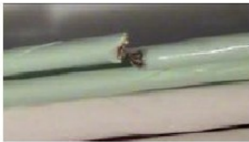
Figure 3-5: Exemple d'un circuit ouvert [7]
