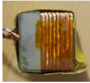
Figure 2.5: La sonde utilisée pour les expériences de cartographie de champ. La boîte mesure 2cm de côté et est remplie de solution aqueuse de NiCl. La bobine possède 8tours de fil de litz, accordée à 350kHz la fréquence de Larmor.
