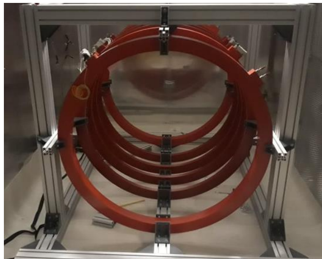
Figure 2.10 : Les six bobines de la structure de Garrett, reposant sur le portique en aluminium.
