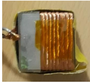
Figure 2.5: La sonde utilisée pour les expériences de cartographie de champ. La boîte mesure 2cm de côté et est remplie de solution aqueuse de NiCl. La bobine possède 8tours de fil de litz, accordée à 350kHz la fréquence de Larmor.
