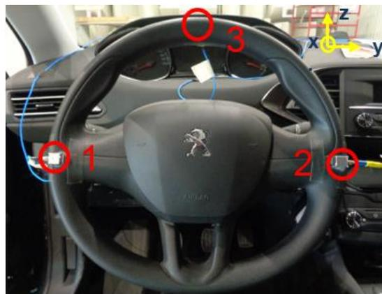
Figure 31 : système de mesure vibratoire volant.
