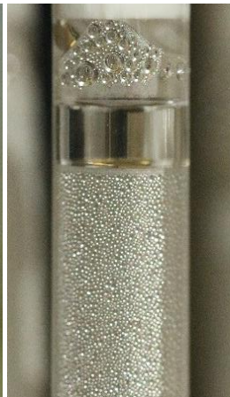
Figure IV-12 : Bouchons de liquide dans des tubes de diamètre 11 mm (gauche) et 8 mm (centre et droite)
