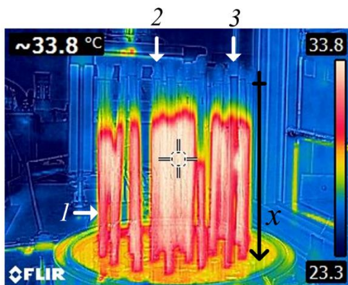
Figure II-10 : Image thermique infrarouge du condenseur en polymère ( \dot{Q}_{tot} = 60 W)
