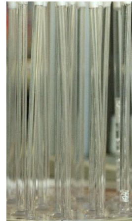
Figure IV-13 : Tubes de diamètre 5 mm envahis par des colonnes de liquide stables
