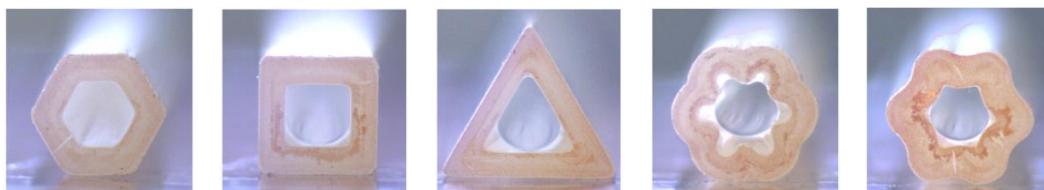
Figure VI-30 : Photographies de l'extrémité des différents tubes après le drainage d'un bouchon de liquide (sections de gauche à droite : hexagone, carré, triangle, cannelé, hexagone réentrant)
