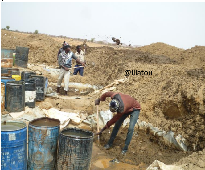
Figure 64 : Evacuation des bassins de cyanuration et manipulation de cyanure sans équipement de protection.
