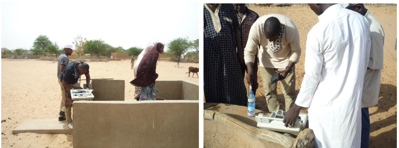
Figure 8 : Prélèvement des échantillons d'eau dans les puits et les forages.
