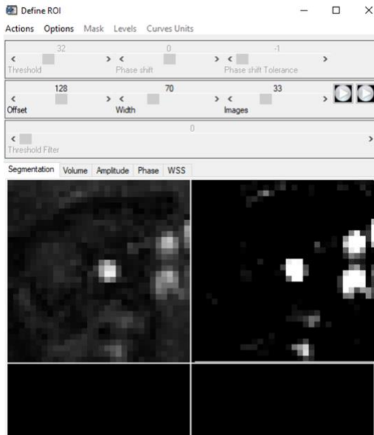
Figure 21 : Vue de l'utilisateur sur le logiciel de traitement, affichant le champ de vue 32 x 32 mm sélectionné en regard de la segmentation semi-automatique de l'image. Plusieurs options permettent de sélectionner le seuil de vélocité (threshold) voulu pour la segmentation, les fenêtres de contraste (offset et width) et de faire défiler les images de la série une par une (images) ou en cinématique (flèches) pour s'assurer que la segmentation est correcte pour l'ensemble des images de la série.
