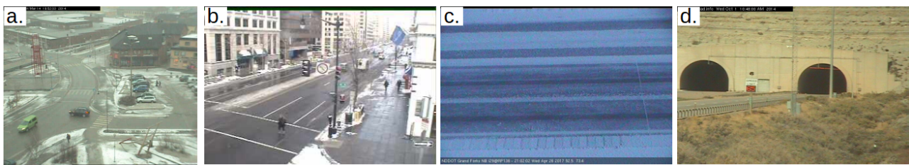
FIGURE A-5 – Les deux premières (AMOS 1550 et 1002) sont des exemples de scènes urbaines, les deux autres sont des exemples de scènes spéciales. La troisième scène est une vue en plongée sur une route de campagne enneigée. Les créneaux en bas permettent d'estimer la hauteur de neige.
