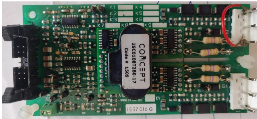
Figure 47. Carte drivers de l'aiguillage de courant
