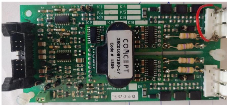
Figure 47. Carte drivers de l'aiguillage de courant
