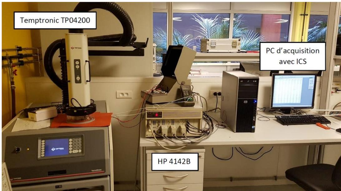
Figure 57. Banc de caractérisation électrique des composants de puissance
