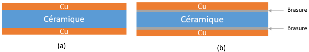
Figure 19. Schéma de coupe (a) d'un DBC, (b) d'un AMB
