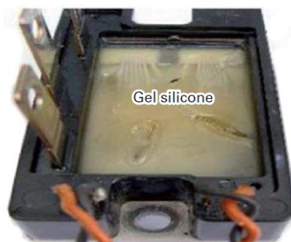
Figure 27. Module de puissance rempli de gel silicone [22]
