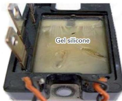
Figure 27. Module de puissance rempli de gel silicone [22]
