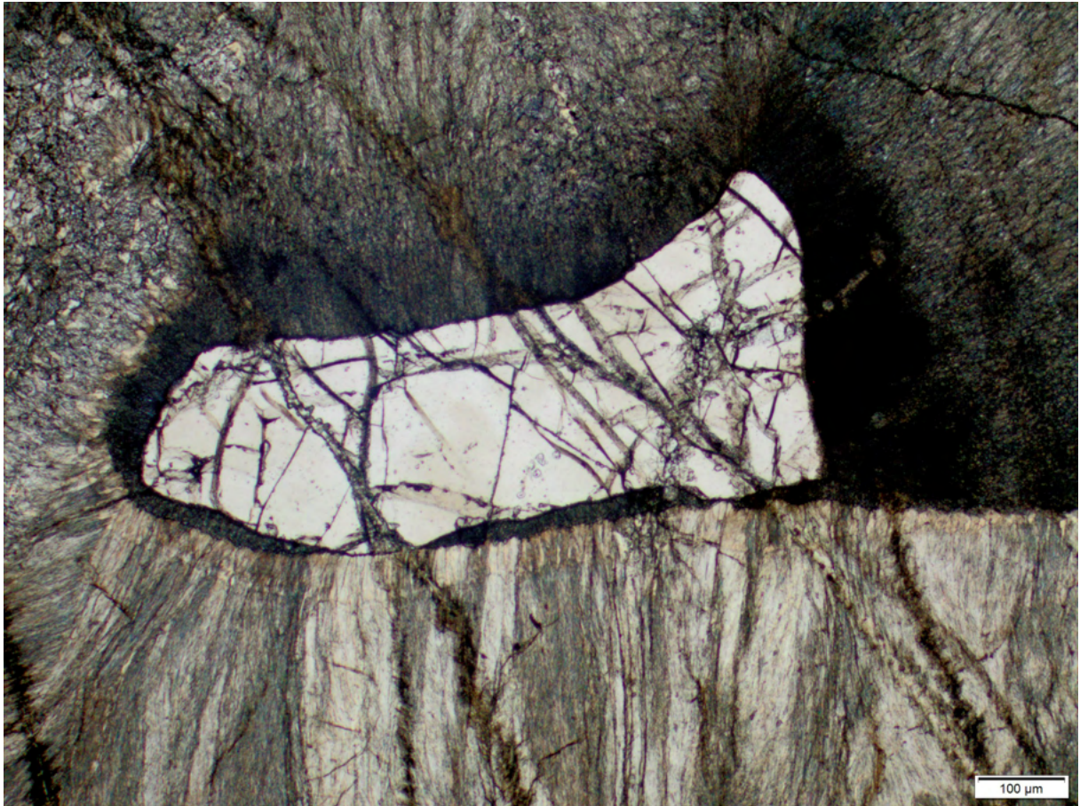
Relique de grenat dans une lherzolite, entourée d'une kelyphite à Opx+Spl(+Cpx).
