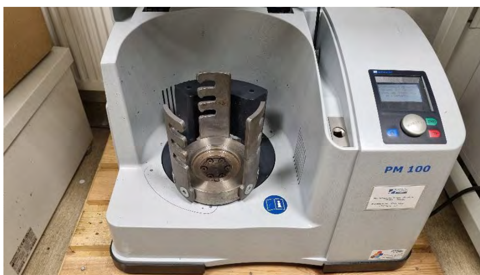
Figure 1 Photographie du dispositif de broyage planétaire.
