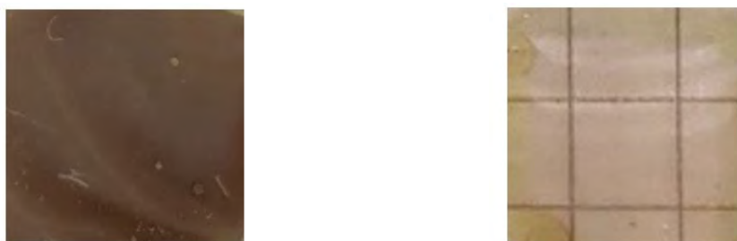
Figure 1 Photographies réalisées sur une feuille à carreaux de films de CsPbI 2 Br déposées sur FTO (à gauche) et FTO/SnO 2 (à droite) par spin-coating à 3000 rpm.
