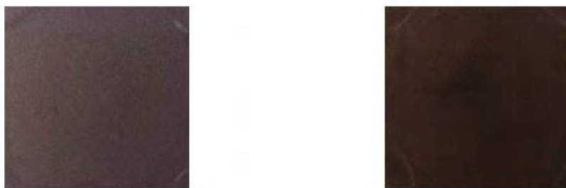
Figure 4 Photographies des dépôts de \text{CsPbI}_2\text{Br} sur FTO et FTO/ \text{SnO}_2 à 4000 rpm en utilisant une solution concentrée à 1,4 M.
