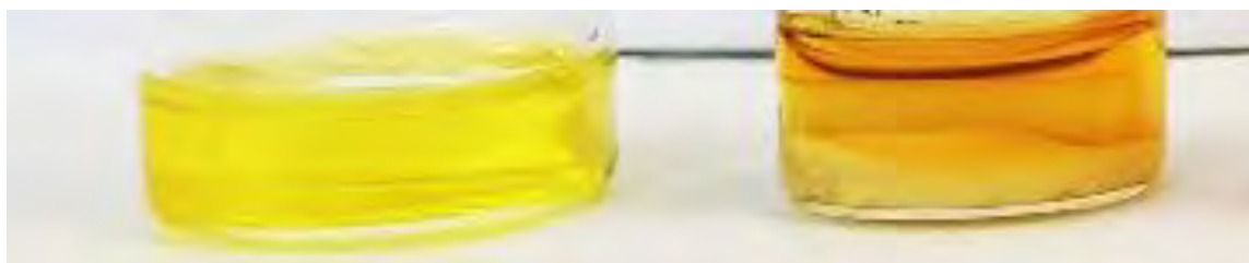
Figure 6 Photographie d'une solution de phase 2D avant et après germination.
