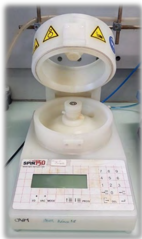
Figure 2 Photographie du spin-coater SPS Spin 150.
