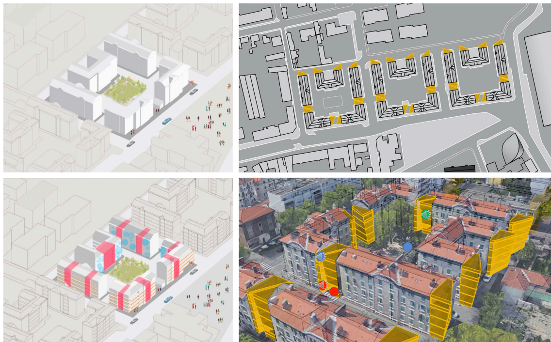
FIGURE 6.18 – "Des balcons traversants" (à gauche) et "Articulations de balcons" (à droite) / Vues en axonométrie et en plan des transformations et de la position des sources
