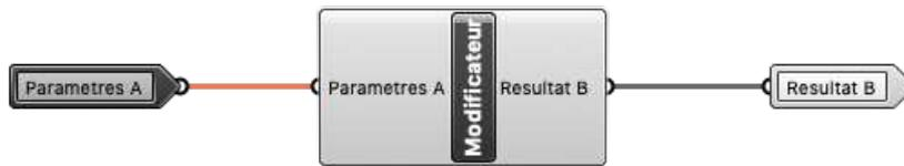
FIGURE 5.9 – Les définitions créées sur Grasshopper sont sauvegardées au format '.gha'. Un script peut donc être résumé à un « fichier » grasshopper qui permet à partir d'une série de paramètres A de générer une morphologie ou un processus B. Il englobe les composants mais aussi les connexions entre eux
