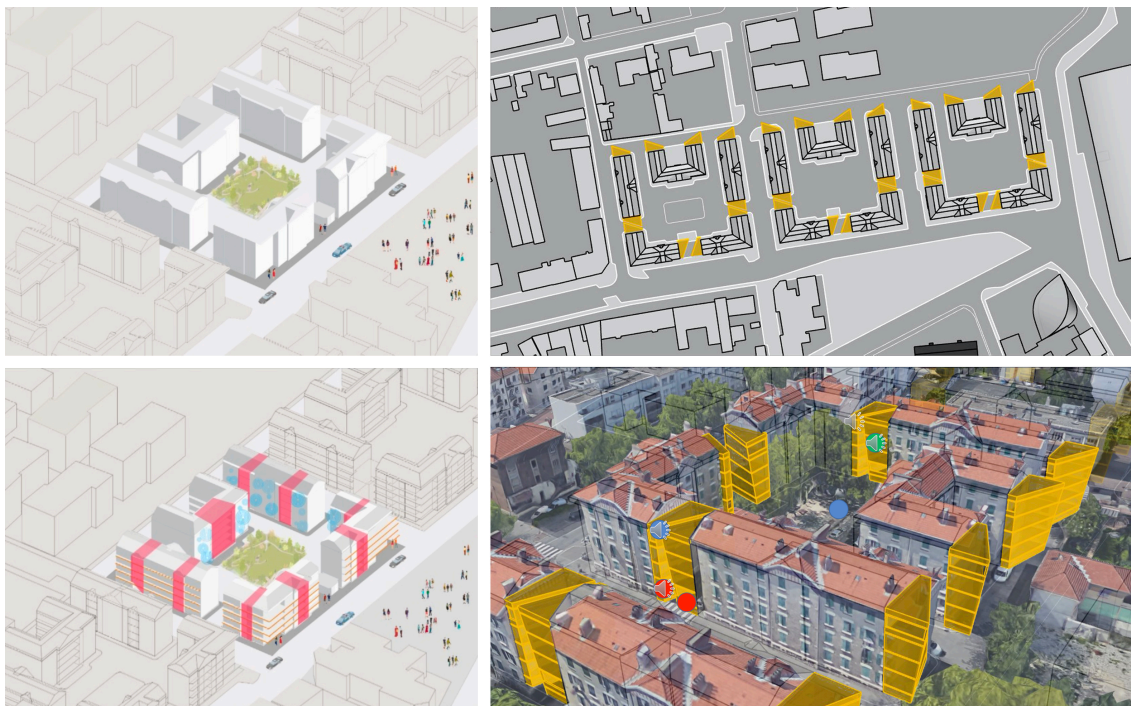
FIGURE 6.18 – "Des balcons traversants" (à gauche) et "Articulations de balcons" (à droite) / Vues en axonométrie et en plan des transformations et de la position des sources
