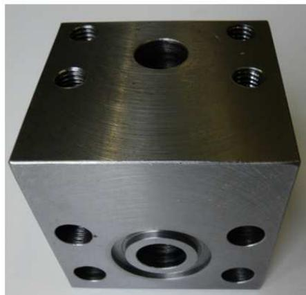
**FIGURE 4.26** – Photo d’un coude à 90° caractérisé sur le banc d’essai
