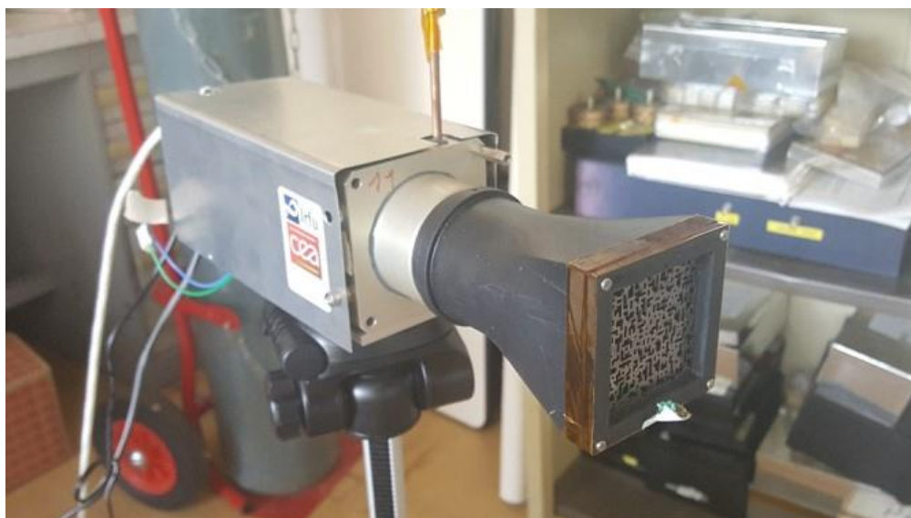
Figure 2-12 : Prototype de caméra WIX sur son pied, équipée d'un masque codé aléatoire.
