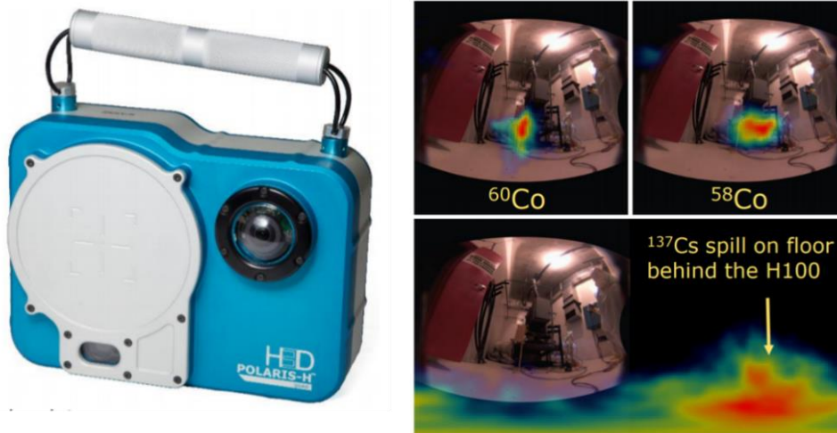
Figure 2-6 : À gauche : la caméra Polaris version H-420. À droite : Exemple de localisation avec la caméra Polaris. (H3D, 2020).
