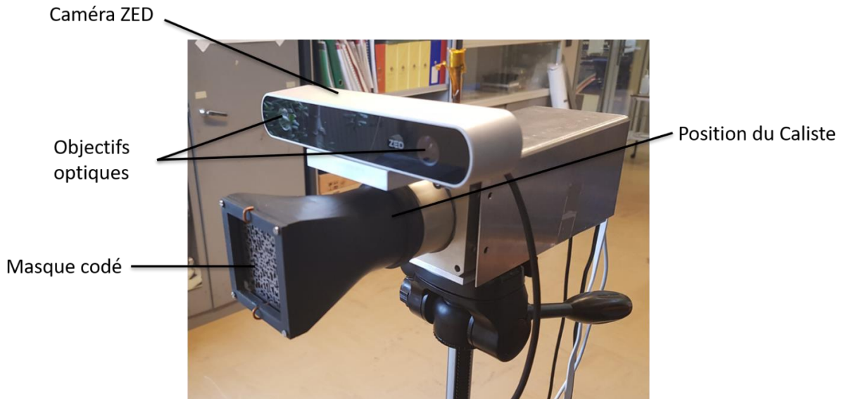
Figure 3-1 : Caméra gamma WIX équipée d'une caméra optique ZED.
