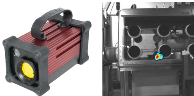
Figure 2-4 : Caméra iPIX (à gauche) et exemple de localisation de source (à droite) (Mirion Technologies, 2019).
