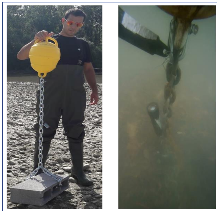
Figure 23 : Les chaînes de thermomètres que nous avons utilisée dans les retenues de seuil (à gauche). Les thermomètres « HOBO U22-00 » immergés dans l'eau (à droite) (Photos réalisées par Francesco Donati,
