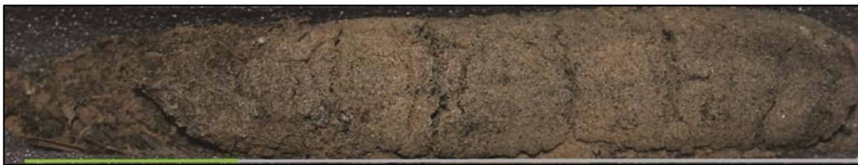
Figure 78 : La carotte prélevée dans le transect T10. La ligne verte matérialise l'horizon principalement organique et celle grise celui minéraux (Photo réalisée par Francesco Donati).
