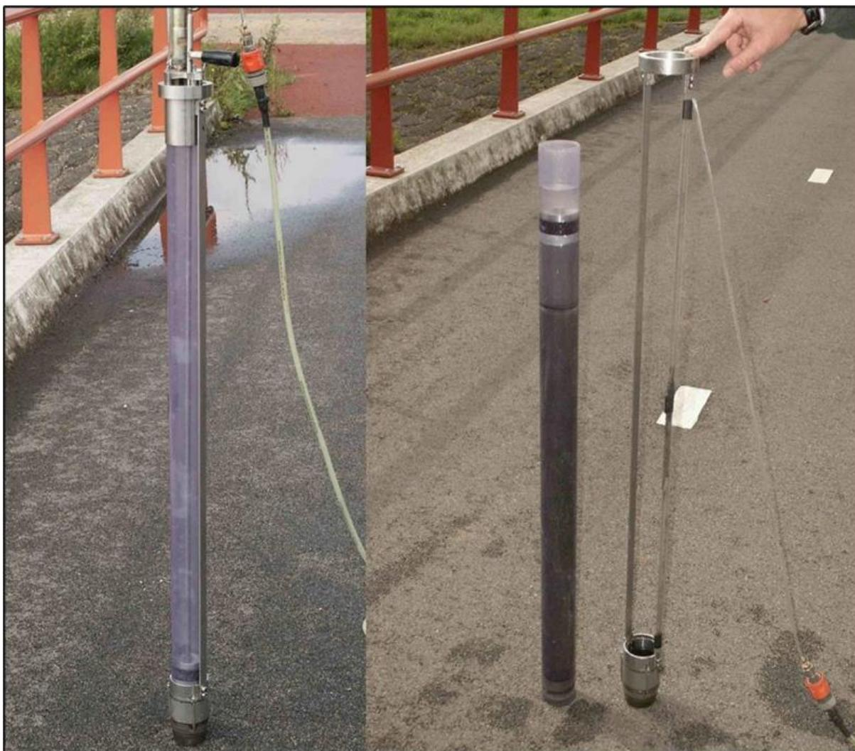
Figure 29 : Le carottier Beaker vide (à gauche) et remplis de sédiments (à droite) (Source : Sedec France).
