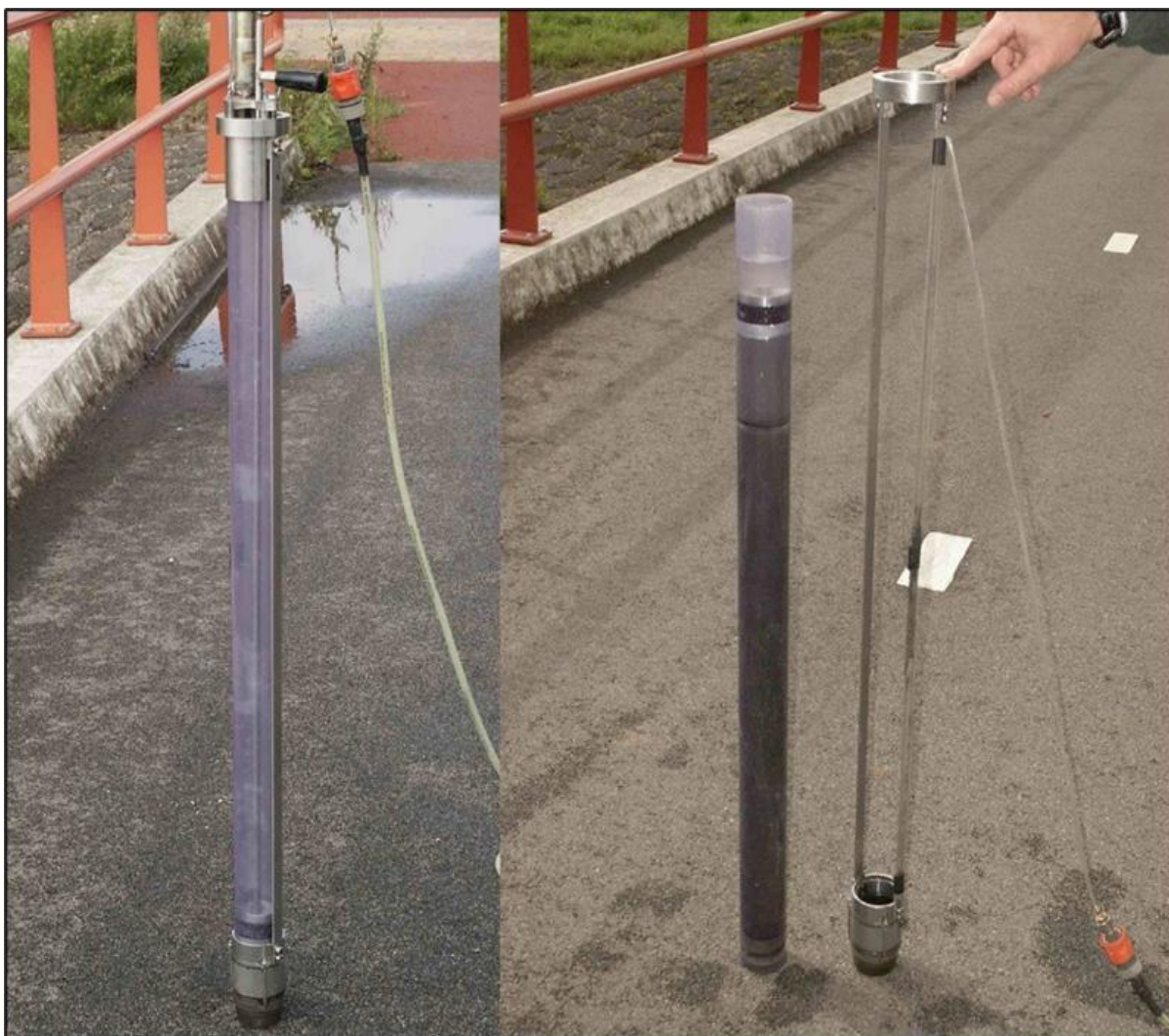
Figure 29 : Le carottier Beaker vide (à gauche) et remplis de sédiments (à droite) (Source : Sedec France).
