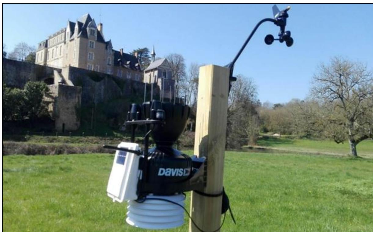
Figure 54 : La station météo installée en proximité de la retenue de seuil de Thévalles (Photo relayée par Francesco Donati).
