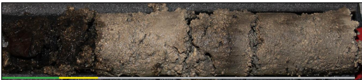
Figure 66 : La carotte prélevée dans le transect T5. La ligne verte matérialise l'horizon organique composé de débris végétaux, celle jaune celui mixte composé de débris végétaux/minéraux et celui gris l'horizon composé de débris minéraux (Photo réalisée par Francesco Donati).
