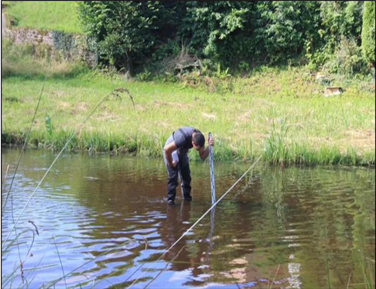
Figure 28 : Les opérations de mesure de la profondeur du substrat dans l'une des retenues de seuil en étude (Photo de Francesco Donati).
