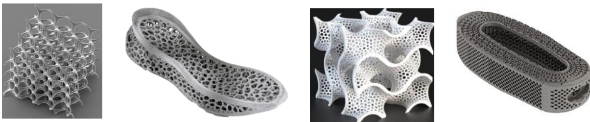
Figure I-3 - Différentes structures 3D poreuses réalisables uniquement en fabrication additive
