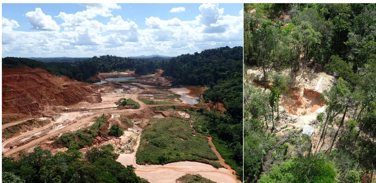
Figure 7 - Photographie aérienne des opérations légales d'extraction d'or : la zone est vaste et composée de bassins d'eau et de sol nu (à gauche). Photographie aérienne des opérations d'exploitation aurifère illégale : seule une petite surface de forêt a été défrichée (à droite). © ONF
