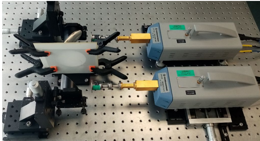
Figure 119 : Mise en place de la mesure des paramètres S d'un échantillon
