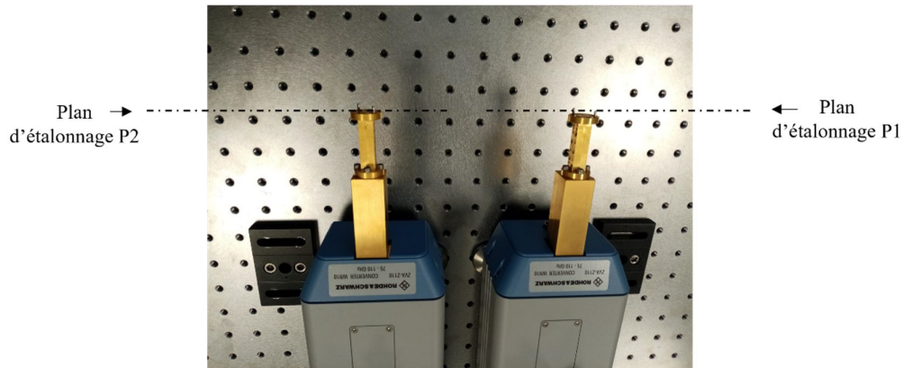
Figure 101 : Photographie des parties émission/ réception du banc et niveau des plans de référence pour l'étalonnage nécessaire pour l'alignement
