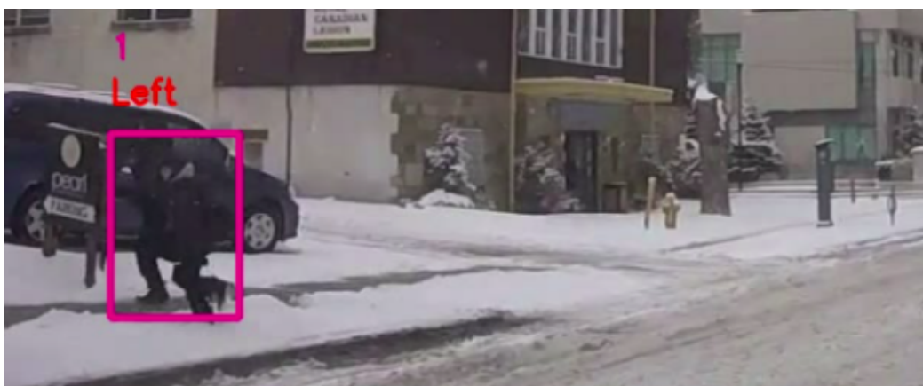
FIGURE 4-7 – Détection de l'orientation des piétons occultés qui courent
