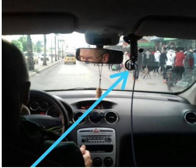
FIGURE 3-4 – Image représentant l’installation de la caméra utilisée à l’intérieur du véhicule pour l’acquisition de la base SafeRoad
