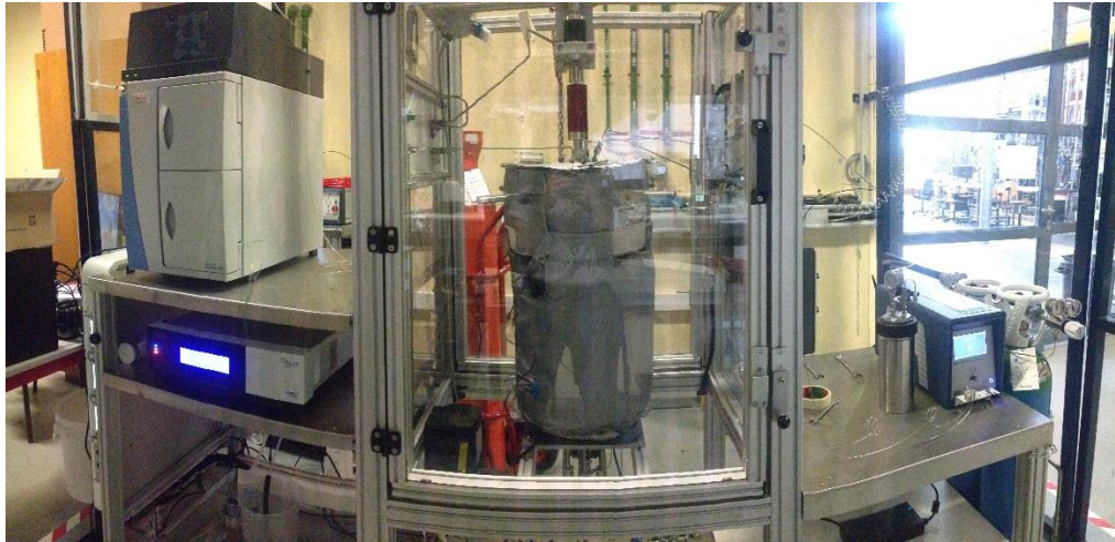
Figure 10 - Photo du pilote expérimental utilisé avec à droite de la photo la chromatographie ionique et à gauche la chromatographie gazeuse.
