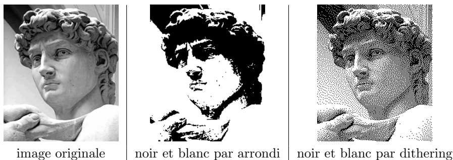
FIGURE 2.2 – Illustration du "dithering" en infographie
