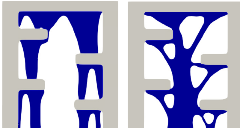
FIGURE 3.12 – Optimisation de forme des supports sans pénalisation de la surface de contact pièce/supports (à gauche) et avec (à droite). Pour ce dernier cas, la condition aux limites de Dirichlet est restreinte à la base du domaine.
