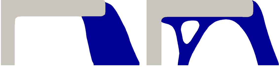
FIGURE 3.9 – Supports optimisés (en bleu) obtenus après minimisation de la compliance (3.10) calculée à partir des forces équivalentes uniquement (à gauche), et après minimisation de la somme des deux compliances (3.11) (à droite)
