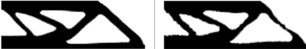
FIGURE 1.19 – Optimisation topologique sans minimisation des contraintes résiduelles (à gauche) et avec (à droite) extrait de [15]
