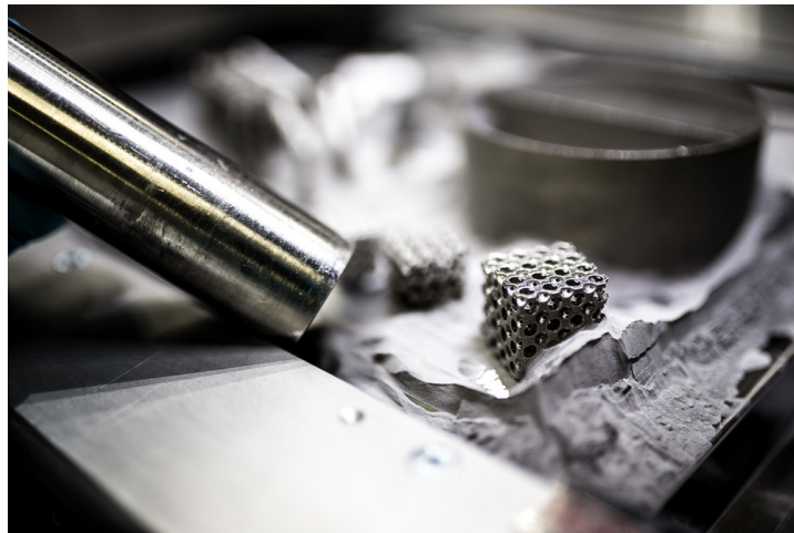
FIGURE 1.12 – Photographie du lit de poudre après fabrication pendant la première étape de dépoudrage
