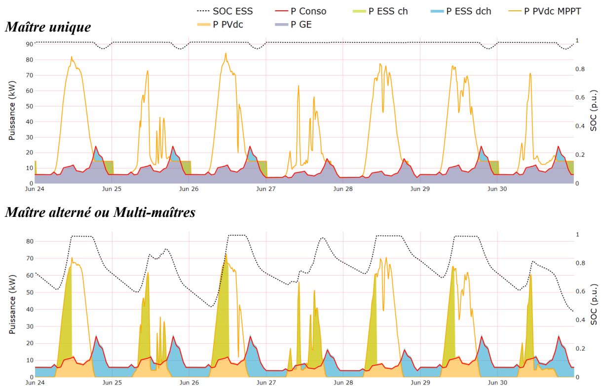
Figure II-13 : Simulation de l'opération du microgrid pour une semaine de juin à la première année avec deux stratégies différentes de contrôle.
