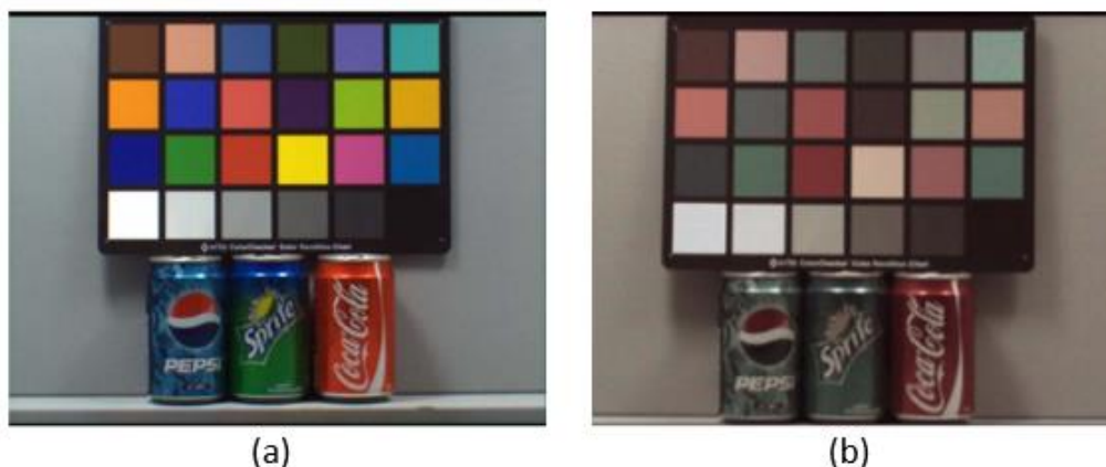
Figure 1.13 : Exemple d'image pour un pixel de 1.1\mu\text{m} et une diaphotie mesurée d'environ 10% (a) et d'un pixel de 0.9\mu\text{m} et une diaphotie mesurée d'environ 20% (b). [46]
