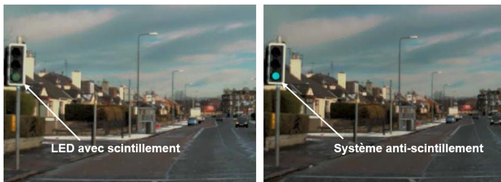
Figure 3 : Contraste dégradé lors d'un éclairage non-continu par LED. [9]
