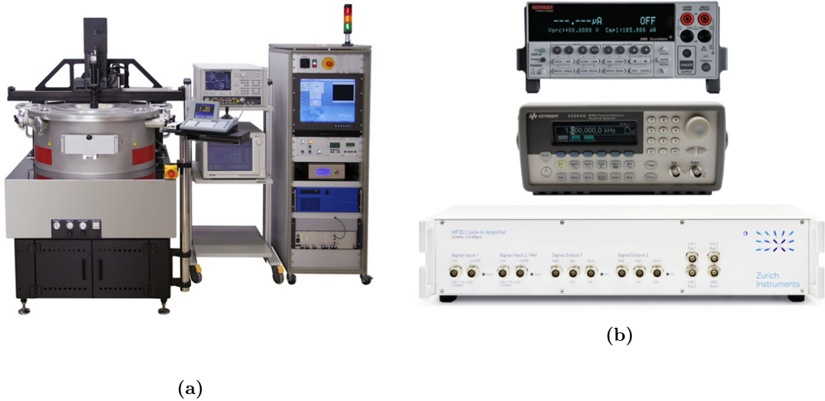
Figure 6.1: Principaux équipements mis en œuvre pour étudier l'effet TPBA : (a) Station de test sous pointes avec contrôle du niveau de vide (PAV 200 Süss Microtec); (b) Sourcemètre Keithley 2400, Générateur Basse fréquence (GBF) Agilent 33250 & LIA Zurich Instrument HF2LI.
