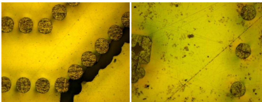
Figure 2- 22 : Problèmes du polissage mécanique : déchirure du BCB (à gauche) et noircissement de la couche BCB (à droite)
