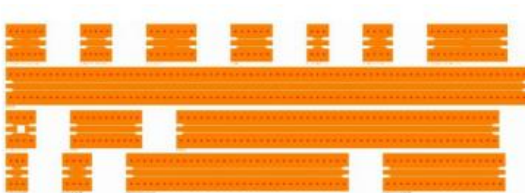
Figure 2- 12 : Une partie du masque pour la fabrication des lignes GCPW avec vias et des accès GSG de différentes longueurs. La ligne la plus longue est de 5 mm.
