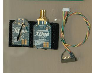
(d) Modems Xbee (D)
