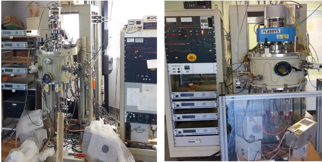
Figure II.4 : Bâtis de pulvérisation cathodique RF magnétron multicibles, à gauche pour le dépôt des films de PZT et de Pt, et à droite pour le dépôt des films de Terfenol-D.
