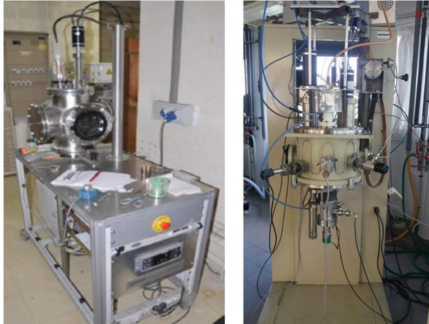
Figure II.5 : Bâties monocibles de pulvérisation cathodique continue à gauche et de pulvérisation cathodique RF magnétron à droite, utilisés pour le dépôt d'or et de TiN respectivement.
