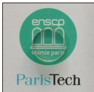
Au terme du post-traitement, les céramiques sont habituellement transparentes (Fig. 86). Compte tenu des températures utilisées, et des observations préalables sur l'évolution de la microstructure lors de frittages naturels à ces températures, la distribution en taille des grains est contrôlée par MEB. Leur répartition, pour une céramique  $\text{CaF}_2:\text{Yb}$  (5% at.), est présentée en figure 87.
