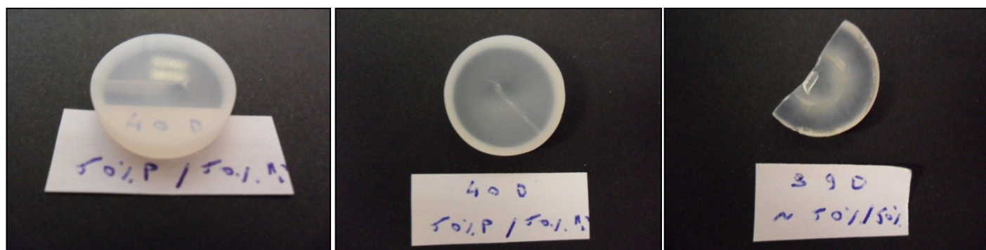
Figure 99 : Céramiques \text{CaF}_2\text{:Yb} (5% at.), issues d'une mise en forme par coulage de poudre redispersées, après frittage naturel à 600\text{ °C} , pendant 1h (les rapports affichés se réfèrent au rapport de masse \text{H}_2\text{O} /poudre dans la dispersion de départ).
