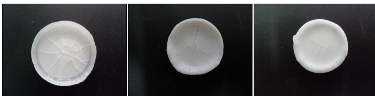
Figure 98 : Fractures dans des corps à cru coulés et séchés sur du gypse respectivement à \alpha_p=10,9\% , 15,93\% et 22,13\% .
