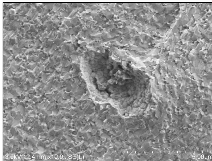
Figure 25 : Porosité large et présentant un granulation de surface, observée sur une photographie MEB-FEG en fracture d'une céramique CaF 2 :Er (5% at.)
