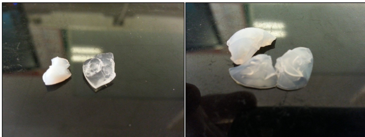
Figure 123 : Fragments de céramiques \text{CaF}_2:\text{Yb} (5% at.) mises en forme par centrifugation puis frittées à 600 °C. Les fragments présentent des disparités de propriétés optiques et de densification. (A noter que l'aspect laiteux observé même sur les bordures disparaît au polissage des pièces, et est donc dû à une rugosité de surface)
