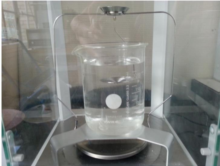
Figure 1-Annexe : Dispositif de mesure de masse de céramiques immergées
