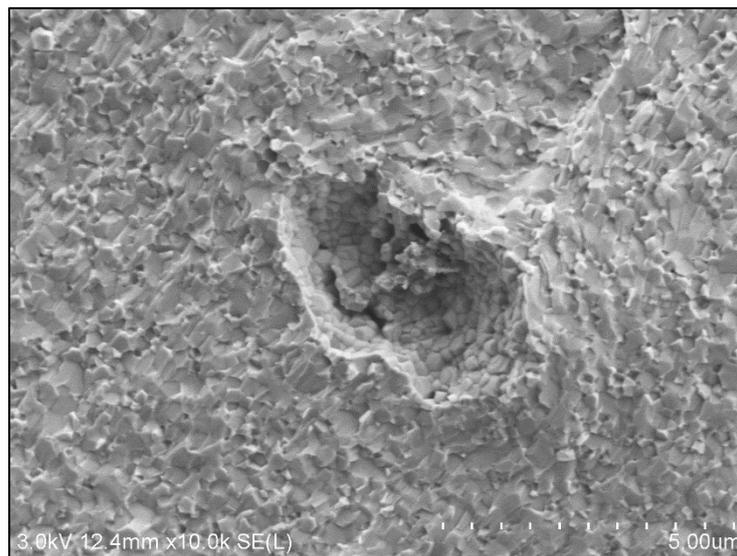
Figure 25 : Porosité large et présentant un granulation de surface, observée sur une photographie MEB-FEG en fracture d'une céramique CaF<sub>2</sub>:Er (5% at.)
