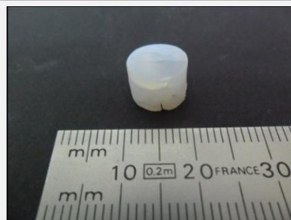
Figure 102 : Céramique  $\text{CaF}_2:\text{Yb}$  (5%at.) issue du coulage d'une dispersion stabilisée par de l'acide fluorhydrique et frittage à  $600^\circ\text{C}$ , 2h
