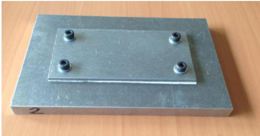
FIGURE 2.30 – Assemblage de Broquere en aluminium avec Chotherm [61]
