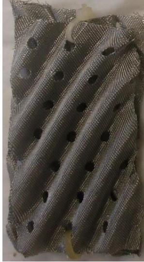
Figure 16 : Support métallique composé de deux feuilles en métal structuré attachées avec un collier de serrage utilisé pour la culture en biofilm dans des bioréacteurs
