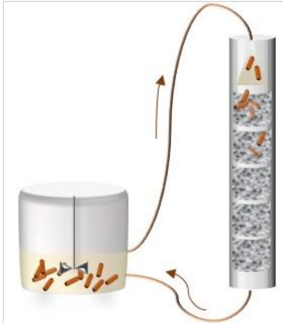
Figure 17 : Schématisation du bioréacteur à biofilm à film tombant, constitué d'un bioréacteur conventionnel de 2 L relié à une colonne renfermant 5 disques de support métallique superposés. Le milieu de culture circule du bioréacteur, où se trouvent les sondes permettant le contrôle du pH et de la température, vers la colonne, puis de la colonne vers le bioréacteur
