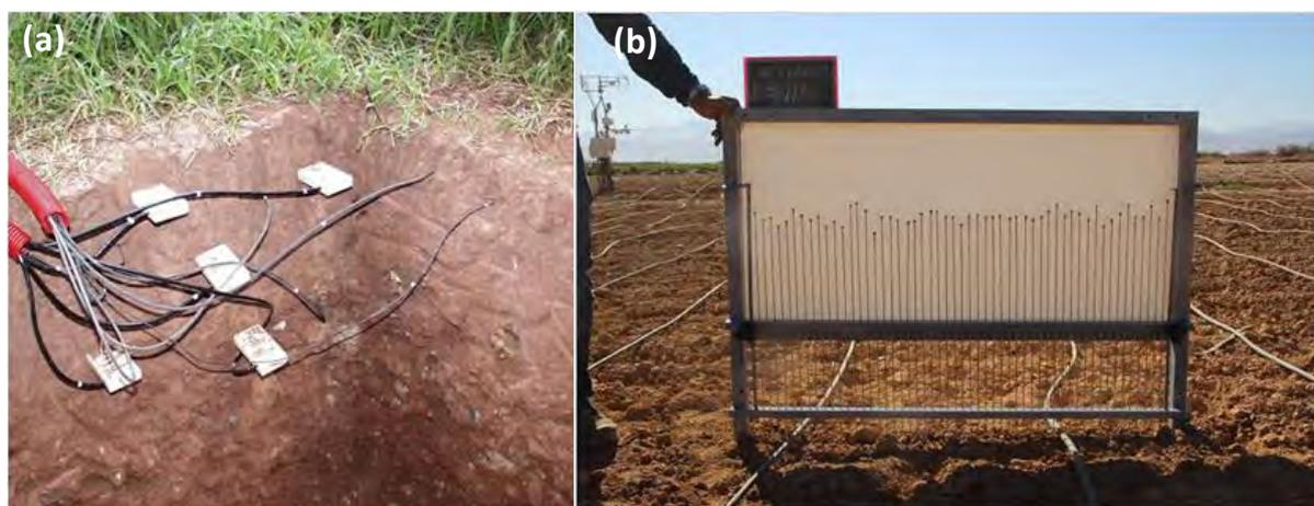
**Figure III. 2 : Exemples de (a) capteurs TDR installés à différentes profondeurs et (b) une image du rugosimètre prise sur une des parcelles labourées avec des tubes d'irrigation goutte-à-goutte installés.**
