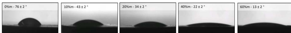
Figure 4. 4 : . Angle de contact entre les pastilles de NCCBr et la phase aqueuse pour différentes concentrations en OEGMA.
