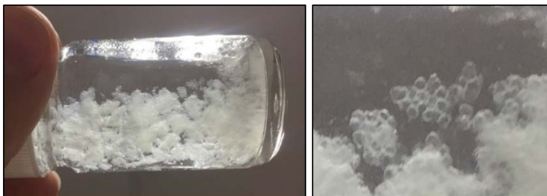
Figure 4. 20 : Photo macroscopique de l'état d'agrégation des gouttes après polymérisation par SI-ATRP.
