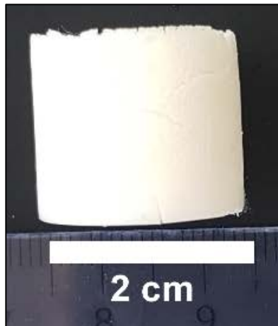
Figure 6. 4 : Monolithe après lavage et séchage obtenu par polymérisation de la HIPE.
