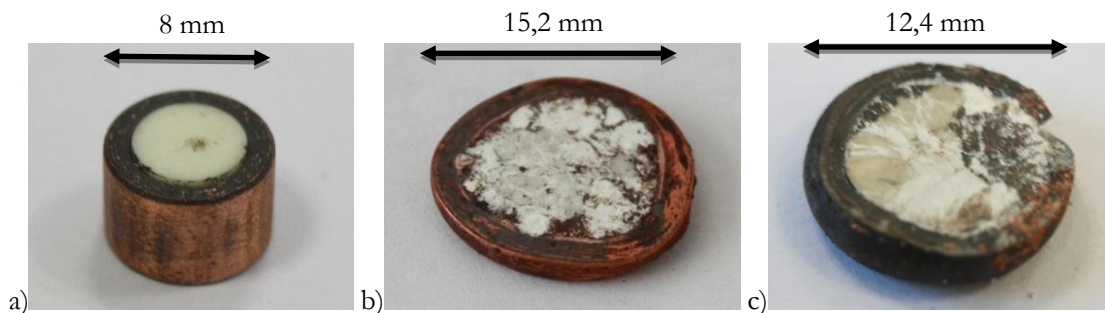
Figure 2-16 : Échantillons de céramique dans son confinement en cuivre, (a) avant essai, (b) après essai et (c) dans son confinement en acier après une compression quasi statique.
