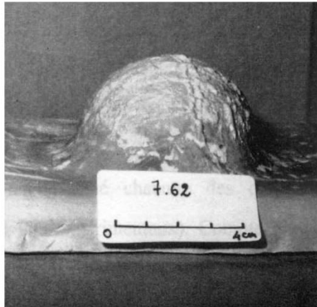
Figure 1-2 : Empreintes moulées dans la plastiline® des déformations arrières après impacts d'une balle de 7,62 NATO sur plaque de polyéthylène 23 kg.m-2 (3300 J) [7]
